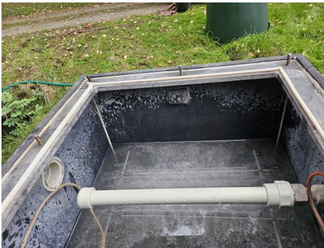
Obr. 10 Tvorba vloček v elektrokoagulační jednotce
