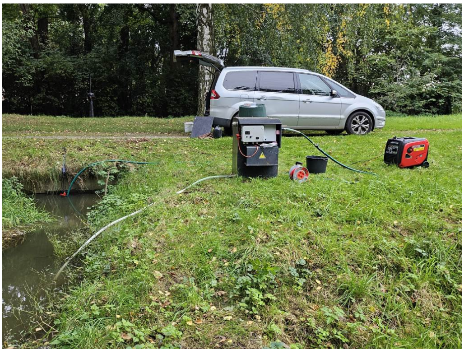
Obr. 7 Elektrokoagulační jednotka osazená na přítoku (řeka Morava) do Podzámecké zahrady Arcibiskupského zámku Kroměříž
